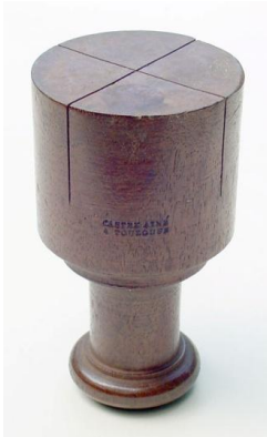
Rys. 4.10. Drewniana węgielnica z pierwszej połowy XIX wieku (według: Tesseract – Antique Scientific Instruments Surveing - http://www.etesseract.com )
