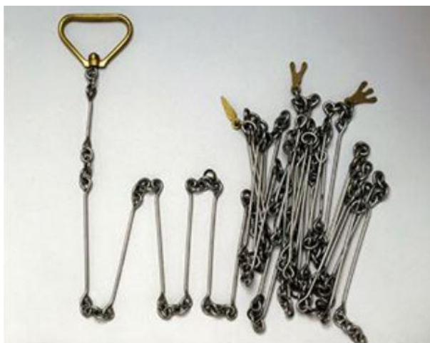
Rys. 2.5. Łańcuch mierniczy (według Antique Surveying Equipment By Dawid – źródło antique.charmlab.org )
