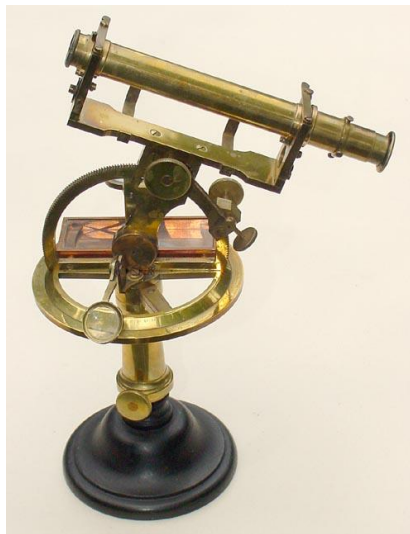
Rys.5.17. Teodolit z ok. 1830 roku (według: Tesseract – Antique Scientific Instruments Surveing - http://www.etesseract.com )
