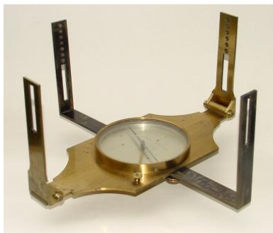
Rys. 5.16. Polski kompas mierniczy z 2 połowy XIX wieku firmy G. Gerlach w Warszawie (według: Tesseract – Antique Scientific Instruments Surveing - http://www.etesseract.com )
